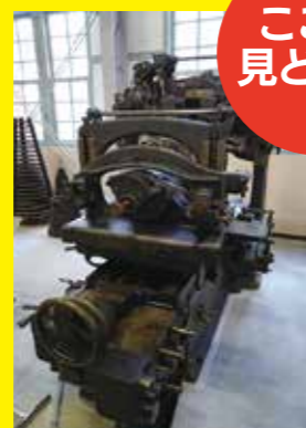
世界最高精度の歯車研削仕上げで知られた歯車研削盤
