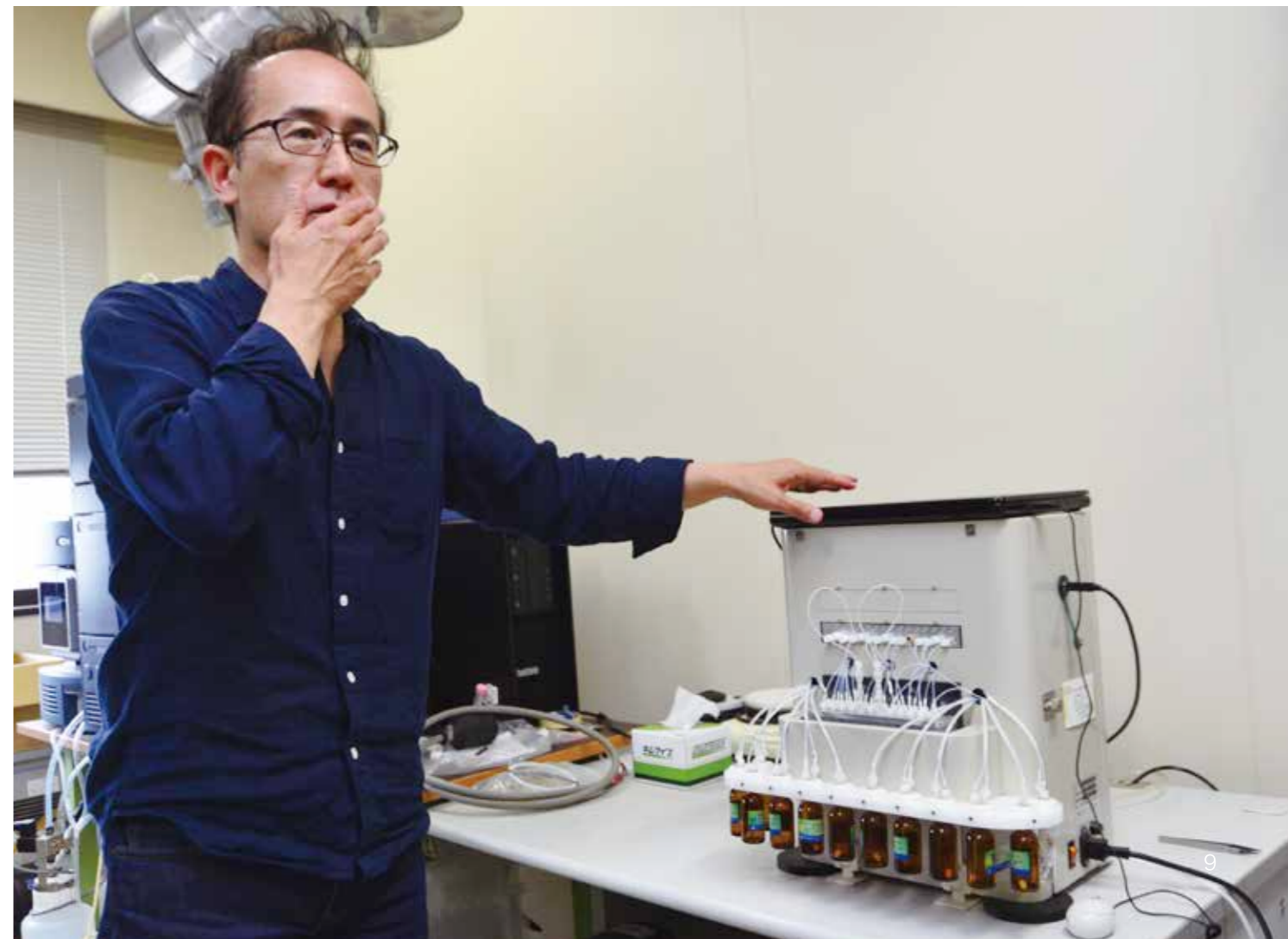
実験に使われるDNA/RNA シンセサイザ。自動で塩基組み合わせを作ることができる
