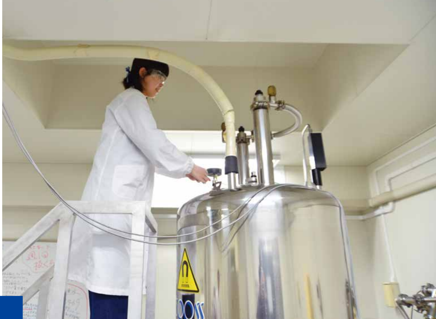
化合物の化学構造を調べる核磁気共鳴スペクトル装置（NMR）。原子のつながりである平面構造や立体的構造を明らかにすることができる
