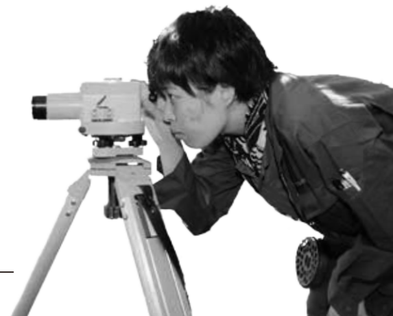
正確な標高を知るための測量
