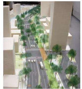
熊本駅前～田崎橋間では、市電のサイドリザベーション化を実施。道路の端に寄せた軌道敷沿いに植樹し、木立ちの中を走るイメージに
