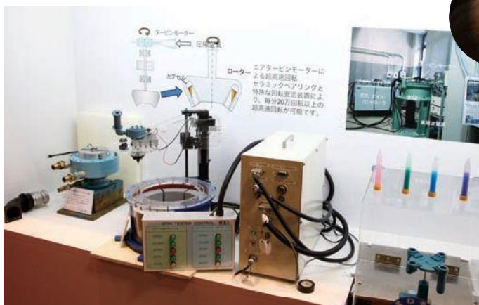
熊本大学の真下研究室が開発した高温・超遠心機の模型と写真。最大100万Gを超える高温・超重力場を実現することができる、無限の可能性を秘めた装置
