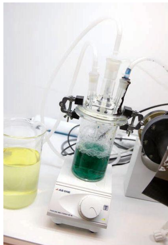
パルスパワーを用いたオゾン発生器の実験。緑色の液体の色素成分は、オゾンによって分解され、左の液体のように変化していく
