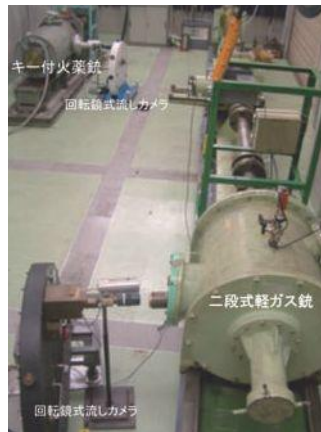
100万気圧以上の固体の衝撃超高压実験を実現する二段式軽ガス銃などの設備
