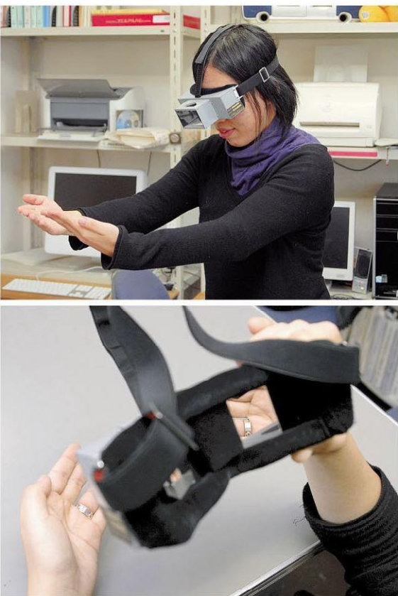
学生も「逆さメガネ」を使って実験をしている（写真上）。このメガネをかけると左手が右に見える（写真下）。
