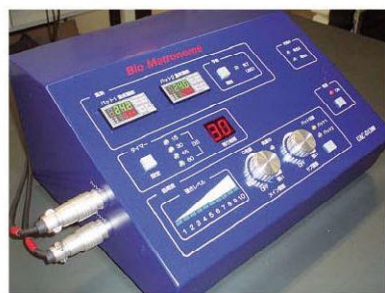
甲斐教授たちが現在開発中の「バイオメトロノーム」。生態に温熱と微弱電流を同時に供給することができ、内臓脂肪の減少効果などが期待されている。
