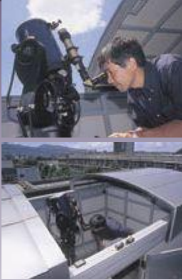
熊本教育学部屋上に設置されているインターネット天文台。開閉式の屋根を備え、全てがオンラインで操作できるようにになっている。
