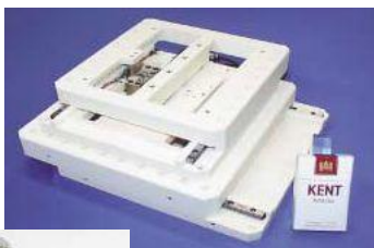
(左) 衝撃・極限環境研究センター、サテライト・ベンチャー・ビジネス・ラボラトリー (上) 上記センターの久保田教授を中心とした共同研究により開発された超精密高速ステージ
