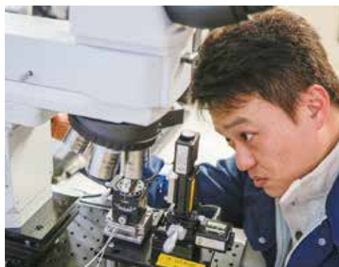
先端材料研究室で開発された「マイクロ材料試験装置」。これを用いて金属材料の機械的特性を調査している。
