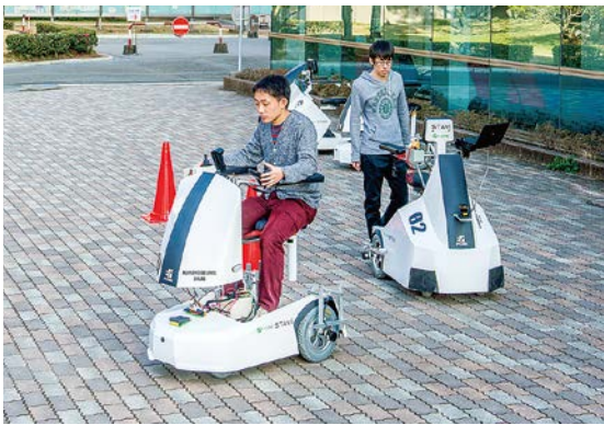
自動運転で「カルガモ走行」を行う「STAVI」。ある物体までの距離を回るセンサであるレーザーレンジファインダを用いて、前方の「STAVI」を追跡
