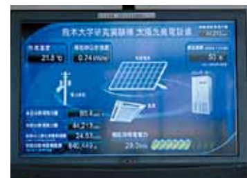
太陽光発電設備表示パネル
