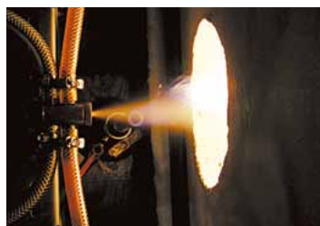
バイオマス燃料・燃焼システム
