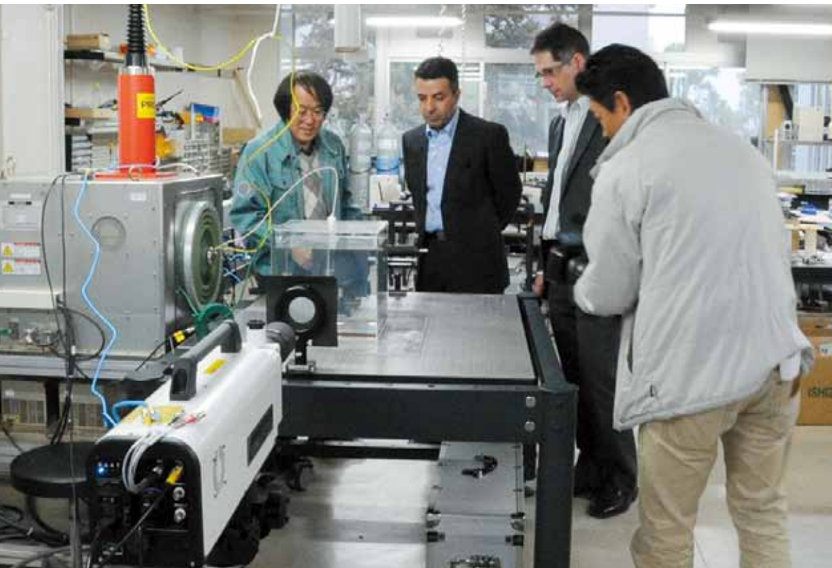
水中放電プラズマ実験風景 秋山教授、ホセイニ教授及びセバスチアン助教が協力して、パルスパワーによる水中プラズマ生成及び衝撃波生成の基礎物理を研究している様子。これらの基礎研究が、アオコ処理、水処理及び多くの衝撃波応用に繋がっている。
