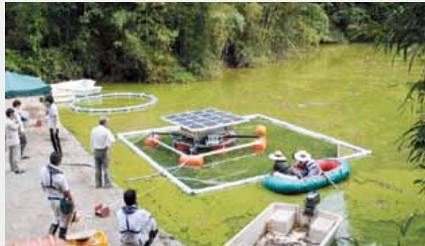
上/氷川ダムにおけるアオコ処理 ダムの水を6mx6m仕切り、その中にアオコ処理装置(MIZUMORI: 水を守るという意味)を設置すると、数十秒できれいになった。 アオコ処理装置は太陽電池で動作する。
