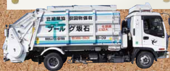
計量機付きごみ収集車(パッカー車)
