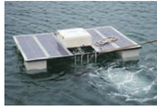
太陽電池と多流体混合装置による マイクロバブルで水質浄化
